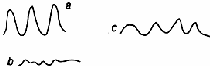
(a) Réponse normale ; (b) Effet produit par le poison ; (c) Le métal empoisonné ressuscite par un antidote.
